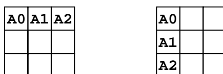
Figura 5. Esquema de la operación colectiva MPI_Scatter().
