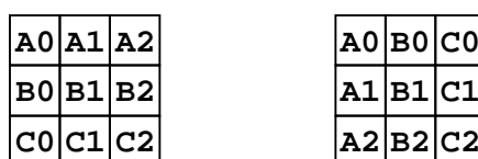
Figura 6. Esquema de la operación colectiva MPI_Alltoall().
